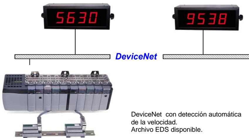
DeviceNet con detección automática de la velocidad.
