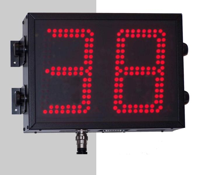
Dígitos de 250 mm de altura. Entorno industrial Visibles hasta a 120m 1 o 2 caras de visualización.
