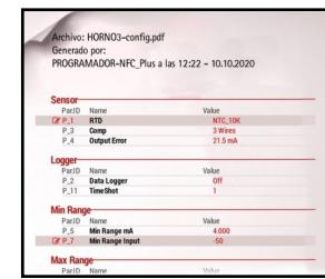
L'onglet SCAN permet de lire les données déjà enregistrées dans l'équipement. En plaçant l'appareil en contact avec le mobile, ce dernier reconnaîtra automatiquement le modèle. L'APP émet un son de notification dès qu'elle détecte l'équipement et ses paramètres.
