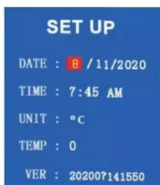
DATE: Ajuste de la fecha mediante los botones arriba y abajo. Confirme el valor correcto pulsando el botón ON/OFF.
