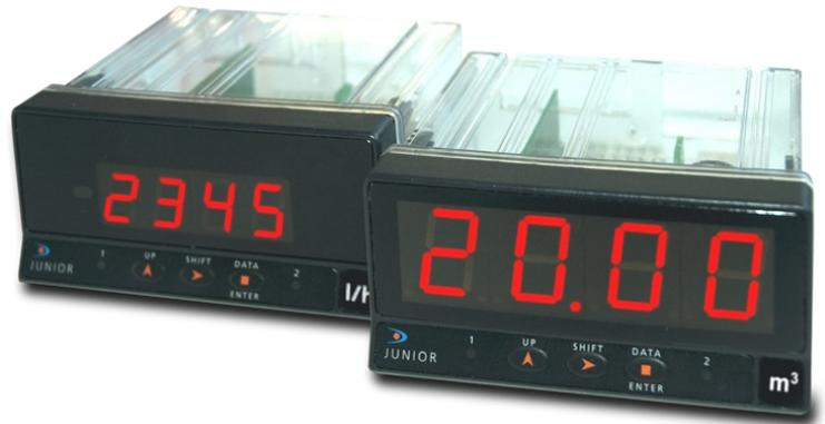
Configurado como contador dispone de un totalizador (**0 a 999999**) y de la función RESET, desde teclado o remota. El primero permite, además de la indicación del conteo actual, la posibilidad de visualizar en dos partes el total de impulsos acumulado en varios procesos. El RESET remoto se realiza a través de la entrada para contacto libre presente en el conector de entrada posterior.
