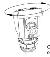
Caja de conexiones orientable
