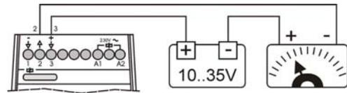
**3 hilos:** Se conectan a los terminales 1, 2 y 3 teniendo en cuenta la polaridad. Es necesaria una fuente de tensión para la alimentación del lazo de corriente.
