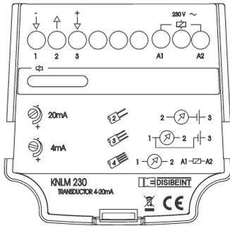
El sensor viene ajustado de fábrica para una lectura de 4-20 mA entre los márgenes solicitados (D). En caso de querer calibrarlo de nuevo, conéctelo según se indica en el esquema. Sitúe el flotador en la parte inferior y ajuste 4 mA en el instrumento mediante el potenciómetro multivuelta [4mA]. Proceda del mismo modo con el potenciómetro [20mA] situando el flotador en la parte superior.
