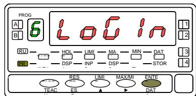
Partiendo del modo de trabajo, pulsar la tecla **ENTER** para entrar en el modo de programación (se visualiza la indicación -Pro-). Pulsar entonces la tecla **▶**, hasta mostrar la figura 31.1. correspondiente al nivel de acceso al módulo de configuración de las entradas lógicas. Se accede a los cuatro menús de configuración de las entradas lógicas mediante **ENTER**.
