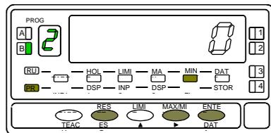
Programación del valor del filtro de ponderación, led FLT encendido. Introducir el nivel de filtro deseado, un valor de 0 a 9, mediante la tecla **▶** para modificar el valor.
