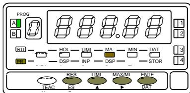
Programación del valor del display en el punto 3, led DSP2 encendido. Introducir el valor dígito a dígito y de izquierda a derecha. Presionar sucesivamente la tecla para modificar el dígito en intermitencia y la tecla para desplazarse al dígito de la derecha hasta completar el valor y el signo deseado. El valor máximo es +32000 puntos y el valor mínimo -32000 puntos. Un valor superior o inferior dará error, dejando 32000 con el signo correspondiente. Introducido el valor deseado:
