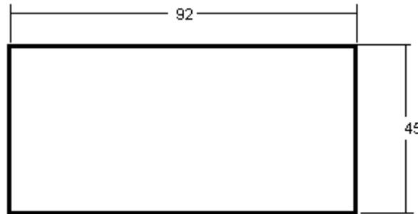
Orificio en panel Espesor mín.: 0.8mm Espesor máx.: 10mm
