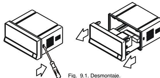
Fig. 9.1. Desmontaje.
