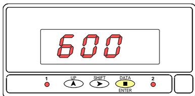
En la figura 15.3 se muestra la indicación correspondiente al tipo de entrada seleccionada con anterioridad. Si se desea modificar este parámetro, pulsar sucesivamente la tecla hasta que aparezca en display el tipo de entrada deseada [600, 200, 20 V]. Presionar **ENTER** para validar la selección. La indicación **Stor** devuelve el instrumento al modo "run" y guarda los parámetros programados.
