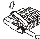
Proceder de la misma forma con todos los terminales y volver a enchufar la regleta en el conector. Los terminales de las regletas admiten cables de sección comprendida entre  $0.08 \text{ mm}^2$  y  $2.5 \text{ mm}^2$  (AWG 26 ÷ 14). Las regletas incorporan unos embudos de plástico incrustados en cada terminal para mantener sujetos los cables de sección menor de  $0.5 \text{ mm}^2$ . Para cables de sección superior a  $0.5 \text{ mm}^2$  deberán retirarse los embudos.
