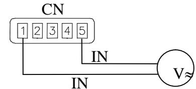
Ejemplos conexionado Alternador tacométrico 60V/1000rpm
