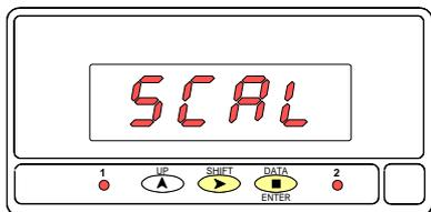
En la figura 17.2 se muestra la indicación correspondiente al método de configuración de la escala del display. Si se desea modificar este parámetro, pulsar sucesivamente la tecla **▶** hasta que aparezca en display el método deseado [**SCAL** = método de configuración por teclado ó **tEAC** = método de configuración por teclado con adquisición de los valores reales de la señal de entrada] y presionar **ENTER** para validar la selección y pasar al siguiente paso de programación.
