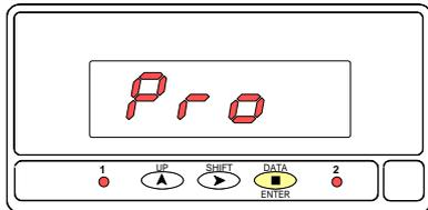
Primero conectar el instrumento a la alimentación, automáticamente, se realizará un test de display activando todos los segmentos del display. A continuación, en el display aparecerá la versión del software de programación, y luego el instrumento se situará en el modo de trabajo o "RUN".
