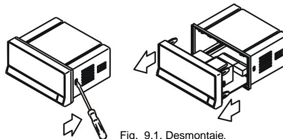
Fig. 9.1. Desmontaje.
