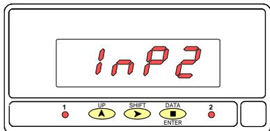
En la figura 17.3 la indicación "InP2" se visualizará durante 2s antes de dar paso a la programación del valor de la entrada en el punto 2 (InP2). Dependiendo del método de configuración elegido la indicación será:
