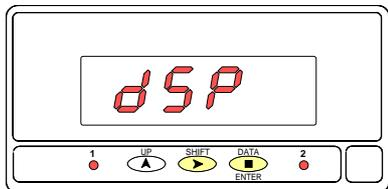
A partir de la indicación "Pro", pulsar **ENTER** y seleccionar mediante la tecla **▶**, el menú de configuración del display (fig. 17.1).
