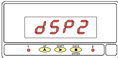
En la figura 18.1 la indicación "**dSP2**" se visualizará durante 2s antes de dar paso a la programación del valor del display en el punto 2 (dSP2).
