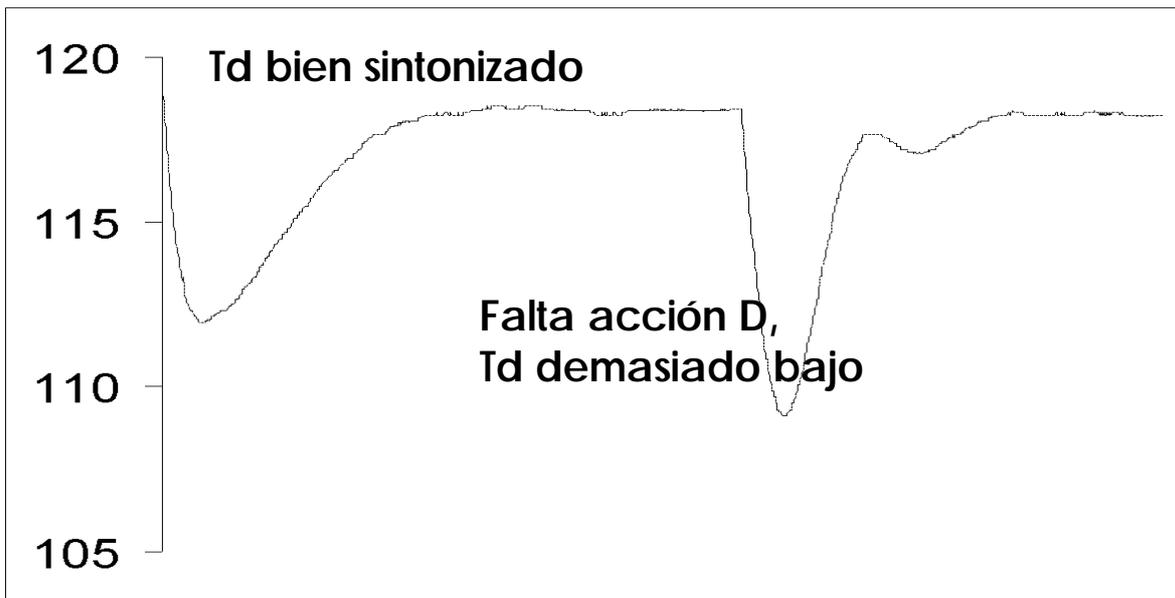
**IMPORTANTE:** Generalmente, debe mantenerse una proporción entre el parámetro  $T_i$  y  $T_d$  de forma que  $T_d$  tome el valor de la cuarta parte del valor de  $T_i$ . Es decir.  $T_d = T_i/4$  (ejemplo:  $T_i=240$ ,  $T_d=60$ ).
