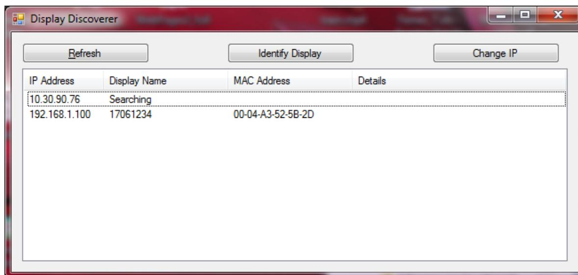
En este caso, la primera fila muestra la IP del PC que se busca los visualizadores y la segunda un visualizador que hemos adquirido. Como se muestra, el visualizador tiene número de serie 17061234 y la IP por defecto se encuentra fuera del rango de IP de nuestra LAN. Para poder acceder al display, lo seleccionamos y clickamos es botón "Cambiar IP". Cuando clickamos se abre una nueva ventana en la que se puede escribir la nueva IP.
