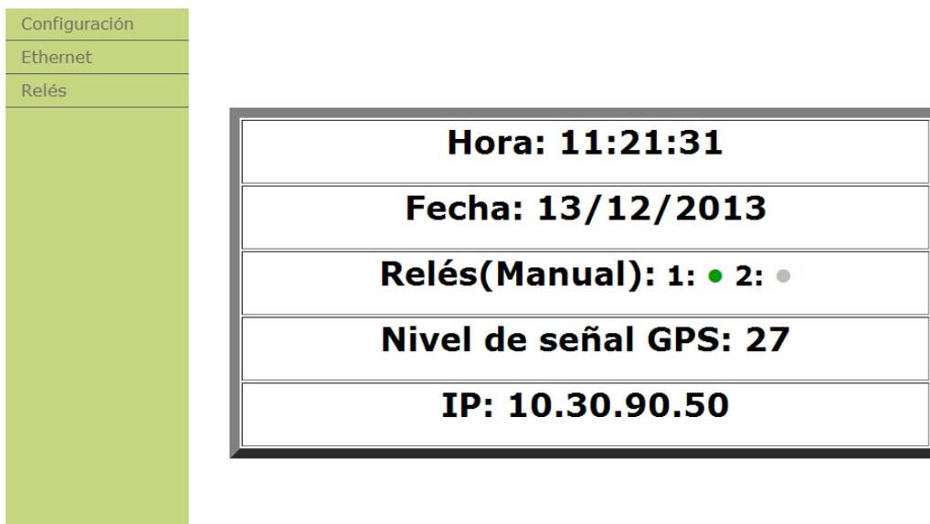
En el menú de la izquierda hay 3 pestañas: Configuración, Ethernet y Relés, accesibles mediante usuario y contraseña. Los parámetros son:
