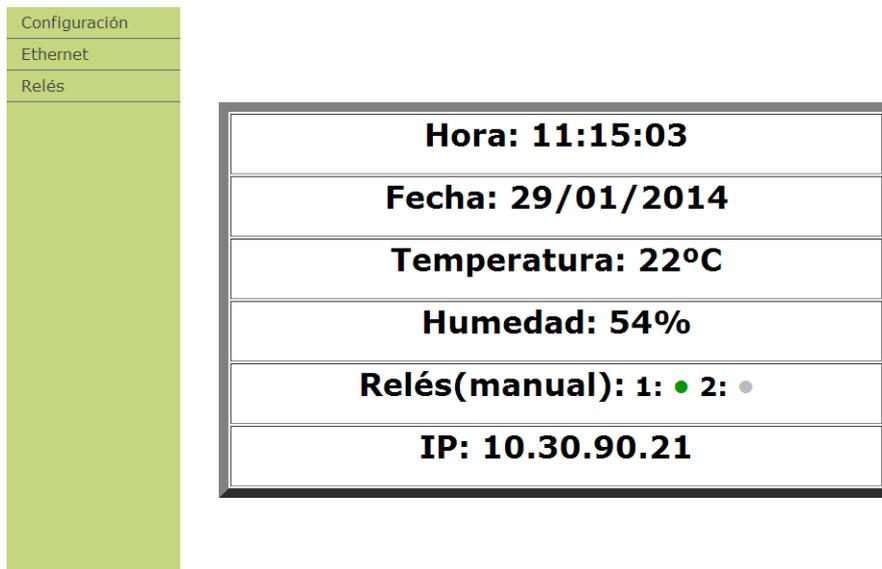
En el menú de la izquierda hay 3 pestañas: Configuración, Ethernet y relés, accesibles mediante usuario y contraseña. Los parámetros son:
