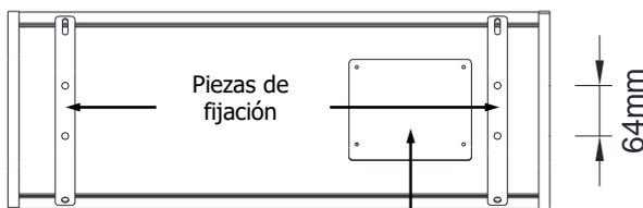
Vista posterior del equipo y raíles horizontales con soportes de fijación
