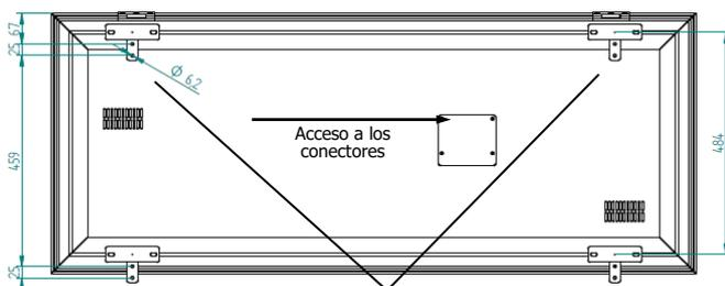
Vista posterior del visualizador con los soportes para su fijación.
