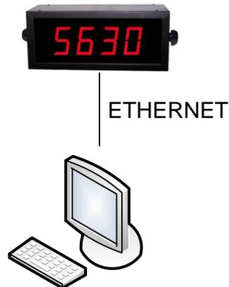
Para conectar varios visualizadores se debe utilizar un concentrador de tipo switch o hub con un puerto para cada equipo.
