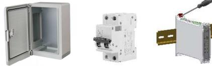
El equipo debe montarse en un riel DIN tipo DIN EN 50022 dentro de una carcasa de plástico o metal con un nivel de protección > = IP65. Todo el cableado debe estar asegurado. Tamaños máximos de cable de 2,5 mm. Conexión mediante terminales de tornillo de dos piezas..
