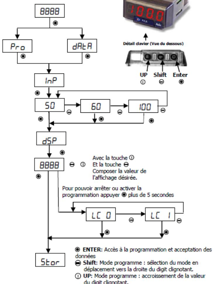
**InP:** Programmation du type de shunt utilisé. 50 mV, 60 mV ou 100 mV.
