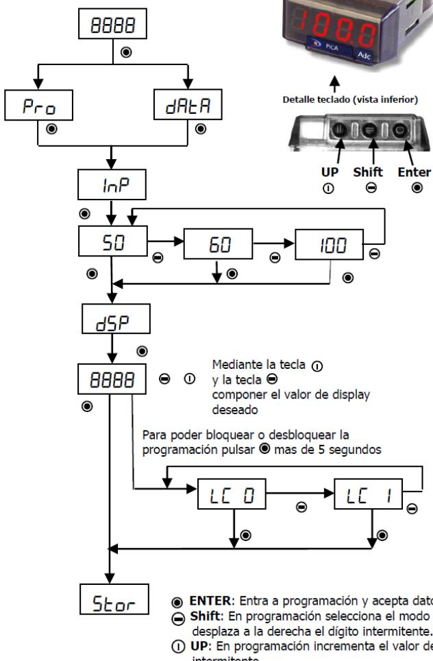
**InP:** Programación del tipo de shunt utilizado. 50 mV, 60 mV ó 100 mV
